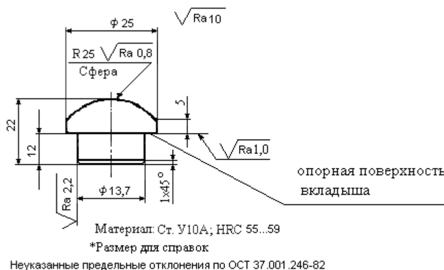
Рисунок 20 – Верхний вкладыш
