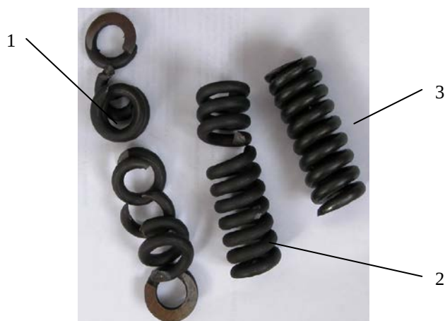
Рисунок 14 – Дефектные пружины гидрозамков подъёмника:
